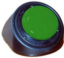
Als Begleitung auf dem Weg der elementaren Kommunikationsförderung ist der Step-By-Step-Communicator eine beliebte Ergänzung zu den einfachen Hilfen BIGmack und One-Step. Auch hier braucht nur eine Taste betätigt zu werden. Dabei können jedoch mehrere Aussagen schrittweise abgerufen werden. Die gesamte Speicherkapazität beträgt 75 Sekunden. Die gespeicherten Aussagen werden in der Reihenfolge wiedergegeben in der sie aufgenommen wurden.
